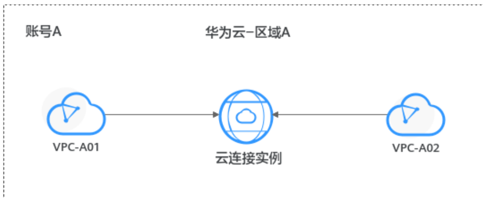
图 3-1 通过云连接实例实现同区域同账号 VPC 互通原理图
